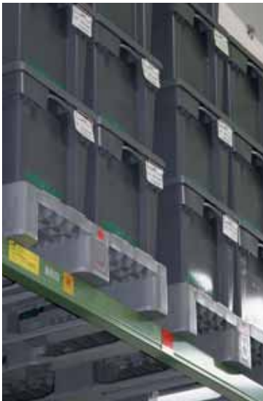
Twistboxen auf H1-Paletten für eine staubfreie Zwischenlagerung in einem der Hochregallager.
