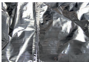
Strahlensterilisierter Inliner mit Sauerstoffbarriere und UV-Schutz
