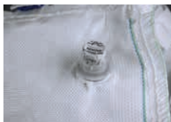
AirAssist mit luftunterstützter Entleerung für hochviskose (> 8000 mpas) Produkte
